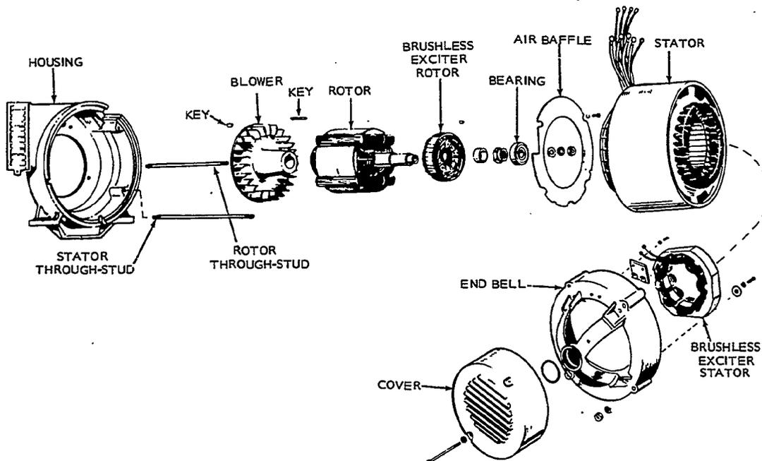
**FIGURE 54. ALTERNATOR DISASSEMBLY**
