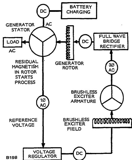
FIGURE 3. EXCITATION BLOCK DIAGRAM
