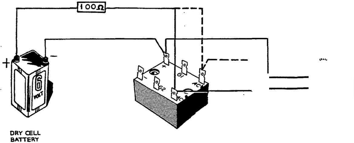
FIGURE 23. TESTING SCR
