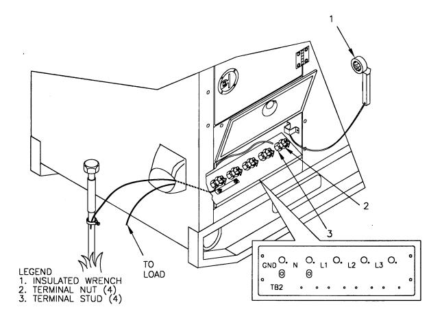
FIGURE 2-7. INSTALLATION OF LOAD CABLES
