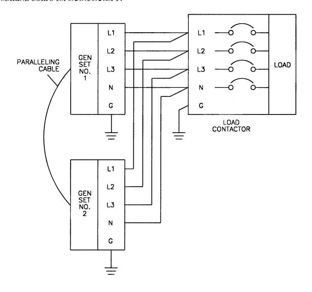
FIGURE 2-10. PARALLEL OPERATION SETUP
