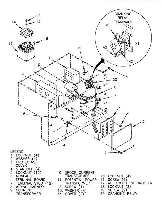
FIGURE 4-28. OUTPUT BOX ASSEMBLY
