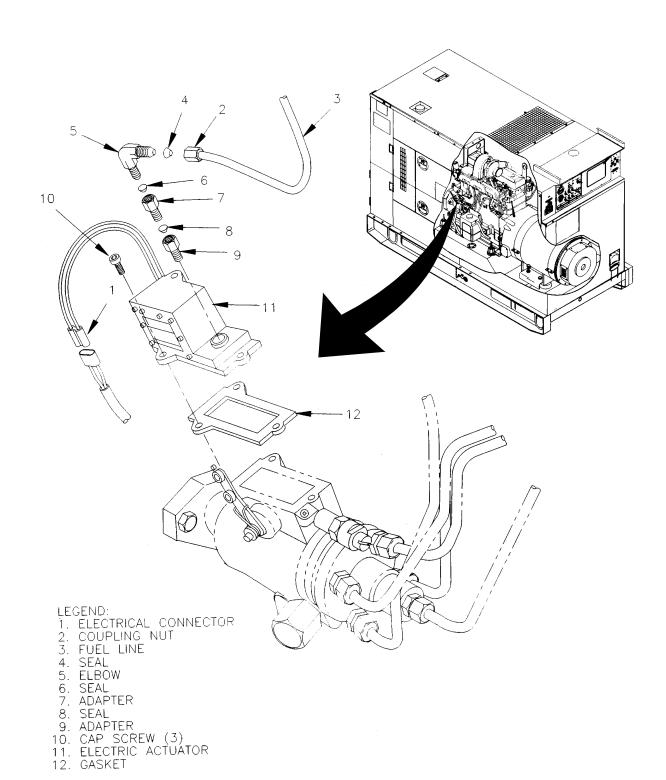
FIGURE 5-7. ELECTRIC ACTUATOR
