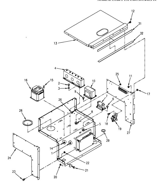
FIGURE 5-4. OUTPUT BOX COMPONENTS
