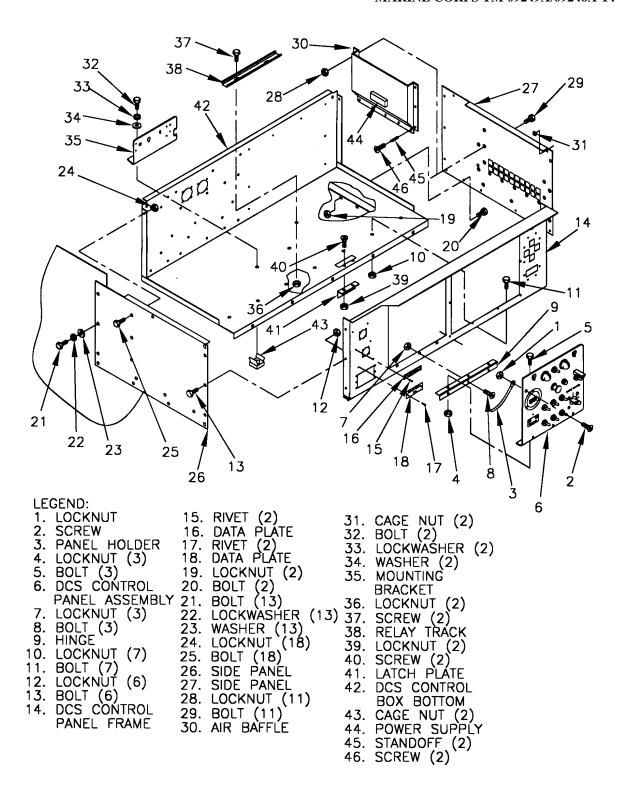
FIGURE 4-18. DCS CONTROL BOX PANELS
