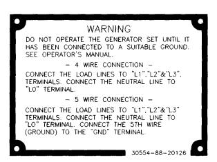
FIGURE 1-9. GROUNDING STUD PLATE
