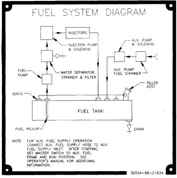
FIGURE 1-16. FUEL SYSTEM DIAGRAM PLATE
