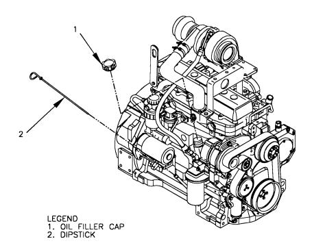
FIGURE 3-6. DIPSTICK AND OIL FILL CAP
