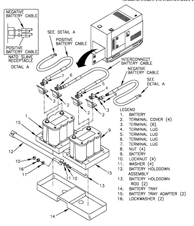
FIGURE 4-3. BATTERIES AND CABLES
