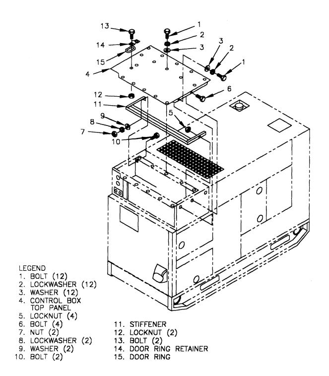
FIGURE 4-6. DCS CONTROL BOX TOP PANEL
