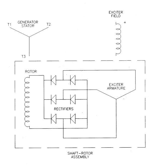
FIGURE 1-28. BRUSHLESS GENERATOR SCHEMATIC
